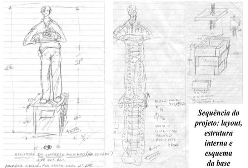
Seqüência do projeto: layout, estrutura interna e esquema da base
