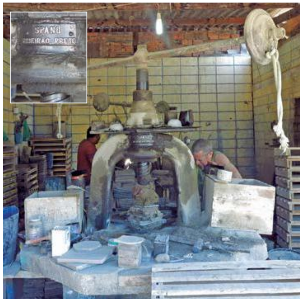
Prensa manual de ladrilhos que pertenceu a Antônio Spanó (hoje está na empresa SA Fábrica de Ladrilhos Hidráulicos, nos Campos Elíseos)
